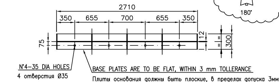
FIXED SADDLE DETAIL Pc.1/ Деталь фиксир. сегла, 1 шт.
